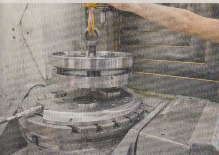
Weil sich mit der AMF-Nullpunktspannung so einfach umspannen lässt, lassen sich eilig zu fertigende Ersatzteile problemlos in den Fertigungsablauf einschieben. (Bilder: AMF)
